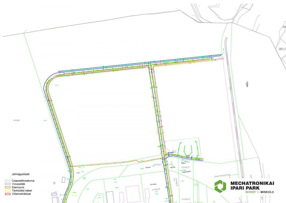
Ábra 5: A Mechatronikai Ipari Park közműtérképe
