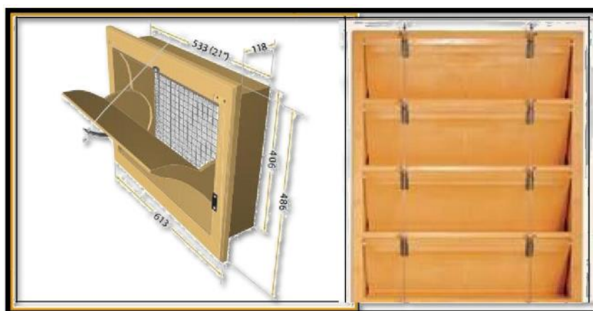
Légbeejtők felépítése
