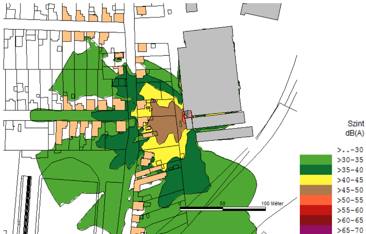
18. ábra: A tervezett STRIKO olvasztókemence zajkibocsátása
