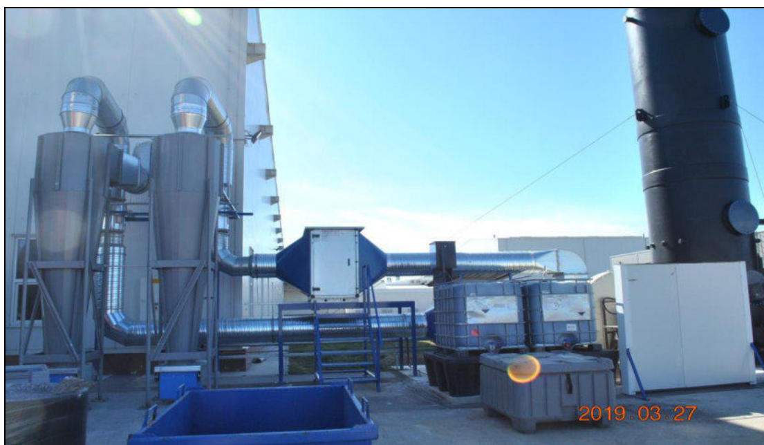
7. sz. ábra: Az északi homlokzat elé épített gázmosó berendezés
