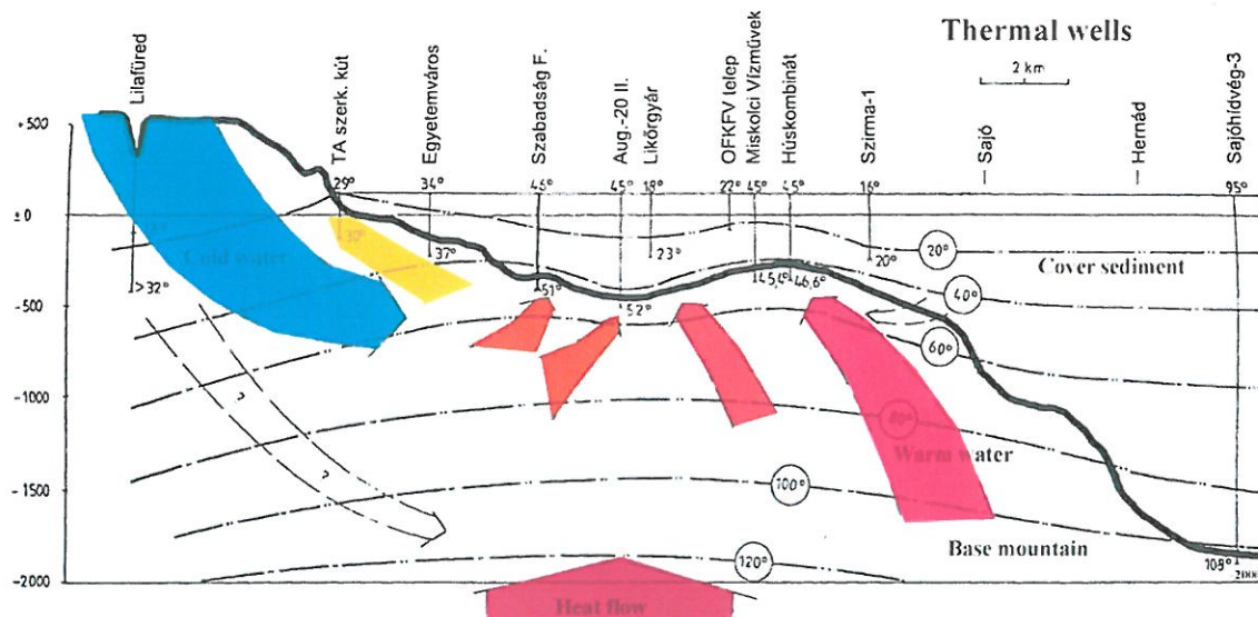
3. ábra: Miskolc környékének termohidraulikai vázlata Hiba! A hivatkozási forrás nem található.
