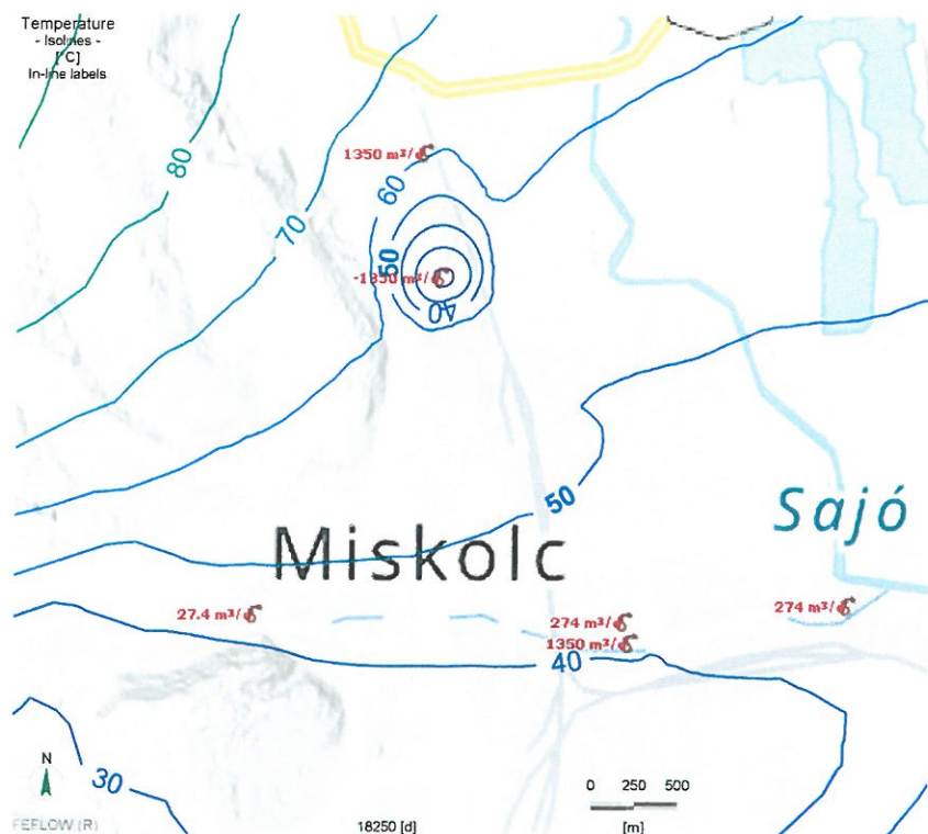
38. ábra: Az 50 év múlva kialakuló számított hőmérséklet eloszlás a termeltetett vízadóban a geotermikus kútpár üzemeltetése esetén (2. modellvariáns)
