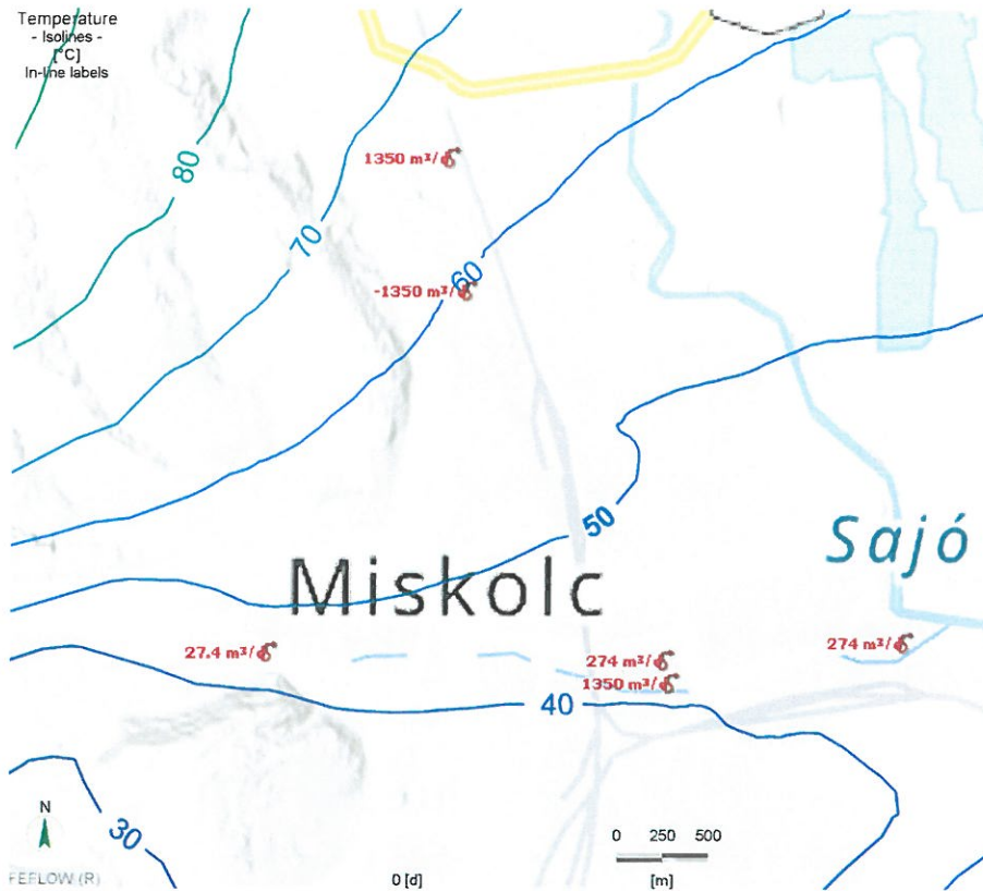
33. ábra: A számított hőmérséklet eloszlás a termeltetett vízadóban a geotermikus kútpár üzemelését megelőzően
