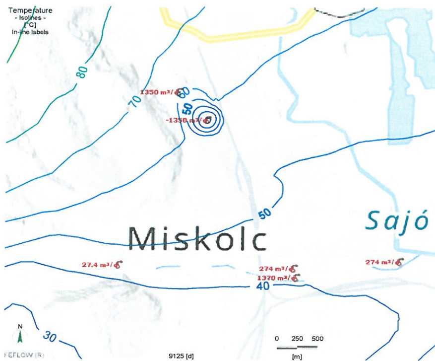
26. ábra: A 25 év múlva kialakuló számított hőmérséklet eloszlás a termeltetett vízadóban a geotermikus kútpár üzemeltetése esetén (1. modellvariáns)
