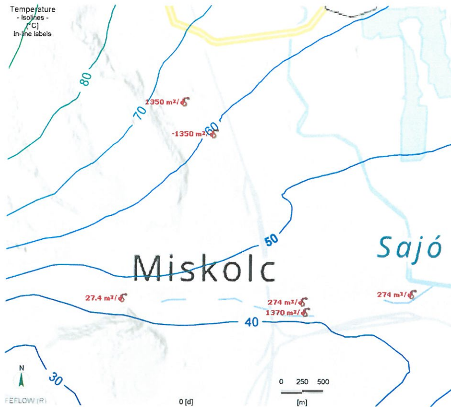
23. ábra: A számított hőmérséklet eloszlás a termeltetett vízadóban a geotermikus kútpár üzemelését megelőzően
