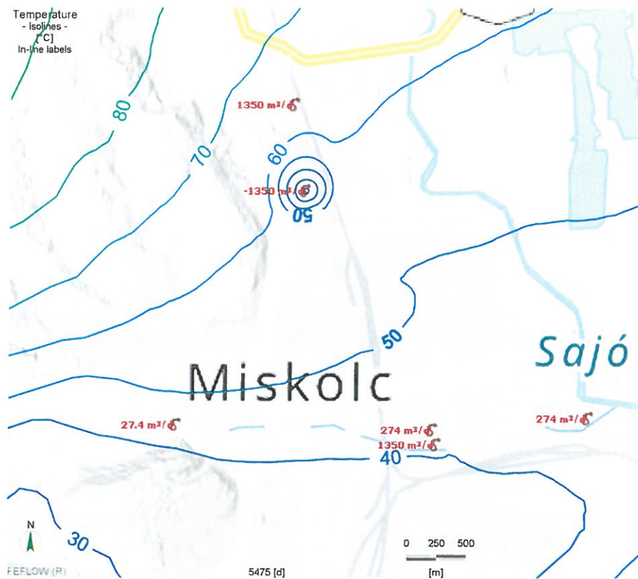
35. ábra: A 15 év múlva kialakuló számított hőmérséklet eloszlás a termeltetett vízadóban a geotermikus kútpár üzemeltetése esetén (2. modellvariáns)
