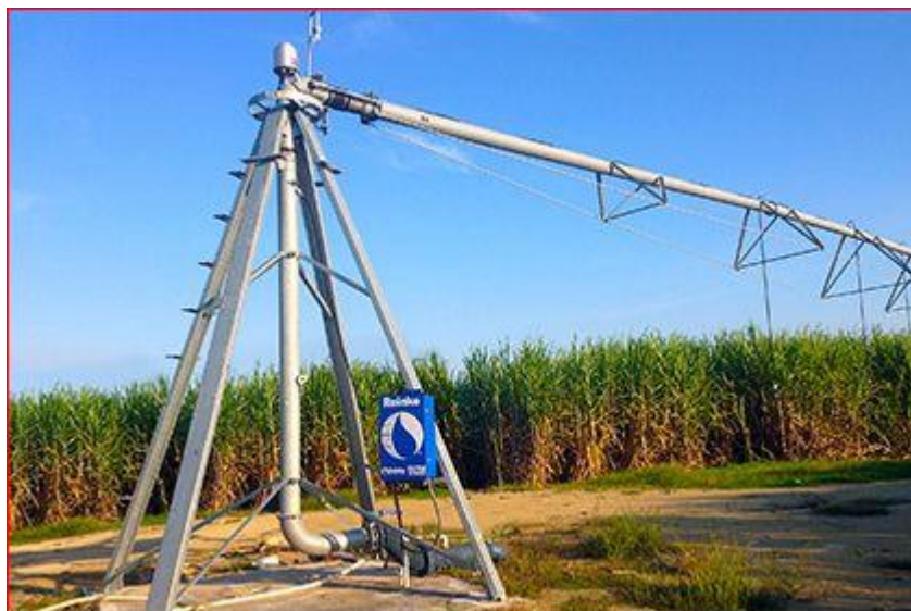
Körforgó öntözőberendezés függesztett öntözőfejekkel
