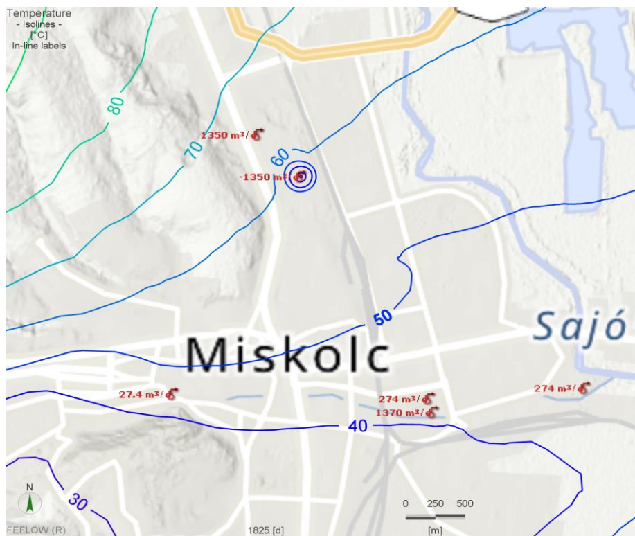
24. ábra: Az 5 év múlva kialakuló számított hőmérséklet eloszlás a termeltetett vízadóban a geotermikus kútpár üzemeltetése esetén (1. modellvariáns)
