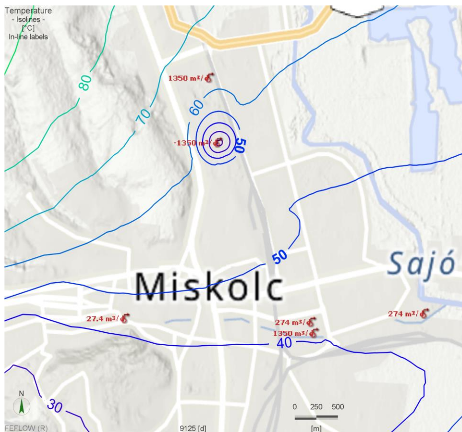
36. ábra: A 25 év múlva kialakuló számított hőmérséklet eloszlás a termeltetett vízadóban a geotermikus kútpár üzemeltetése esetén (2. modellvariáns)
