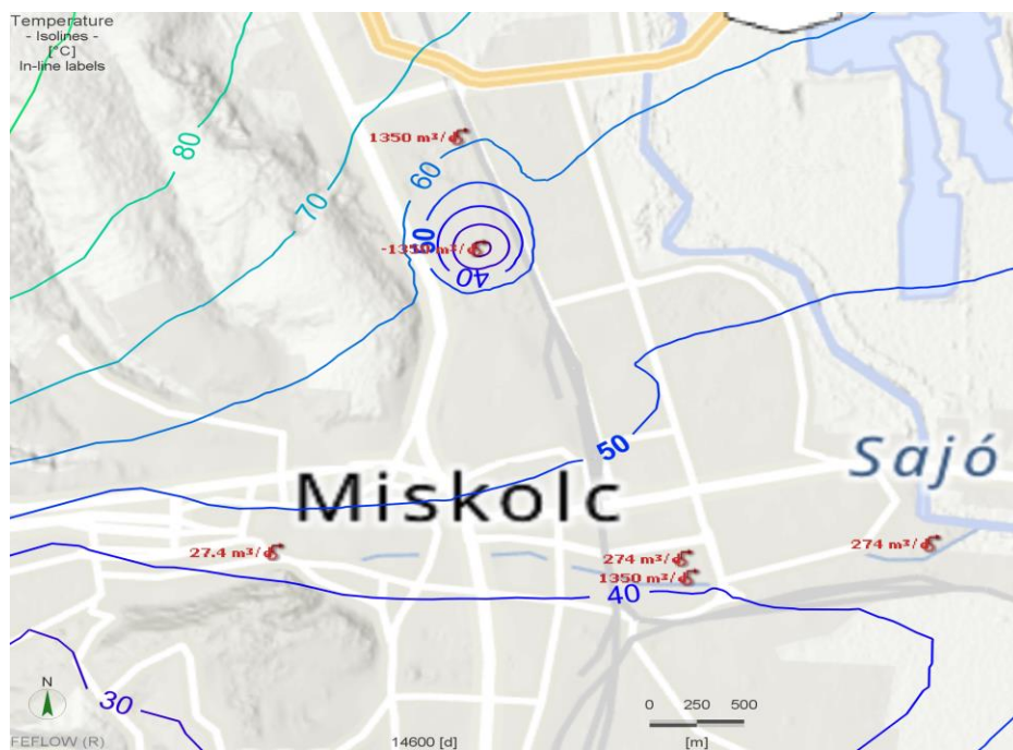
37. ábra: A 40 év múlva kialakuló számított hőmérséklet eloszlás a termeltetett vízadóban a geotermikus kútpár üzemeltetése esetén (1. modellvariáns)
