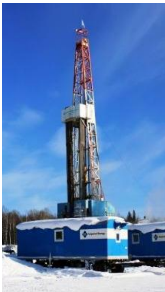
4. fotó: UPA-100 típusú fúróberendezés (forrás: https://www.energydais.com/flowtech-energy/upa-100-9122 )
