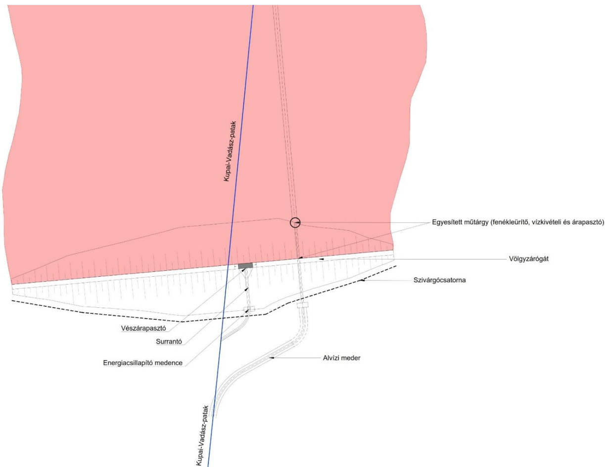
2. ábra: A völgyzárógát szerkezete
