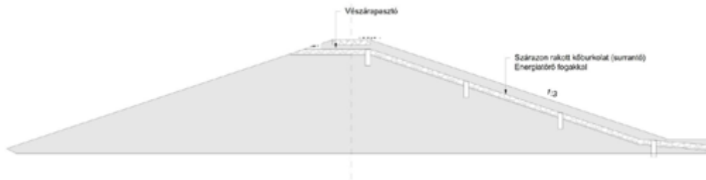
13. ábra. Vészárasztó elvi hossz-szelvénye
