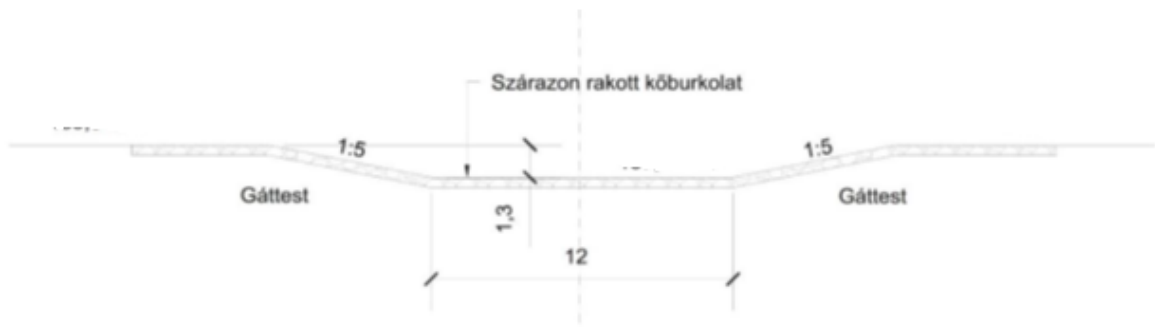
12. ábra. Homlokbukós vészárasztó elvi kialakítása
