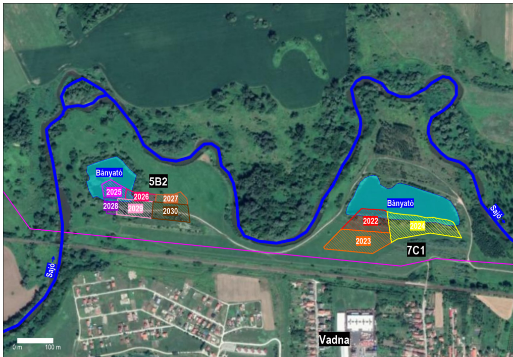
6. ábra: Tervezett fejtési ütemezés az I. bányauzemben (szén), a 2022-2030 közötti időszakban
