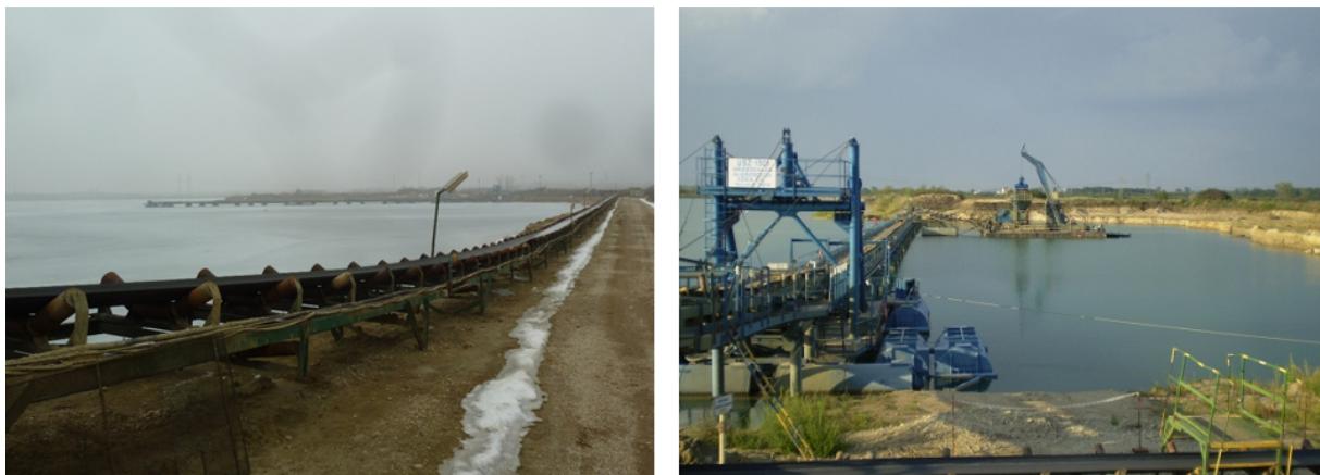
2. kép: A parti szállítószalag és az úszókotró az úszó szállítószalaggal
