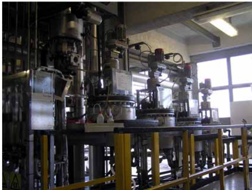
5. kép Az EHP gyártás reaktorai. Balra a filmreaktor alja látszik, jobbra a négy utóreaktor
