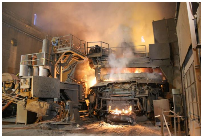
4. fotó: Az ívkemence olvasztás közben
