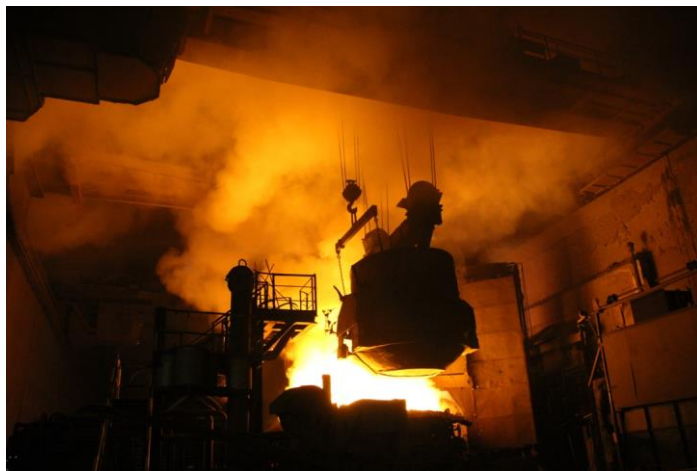
3. fotó: A hulladékkosár emelése a kemencetest fölé
