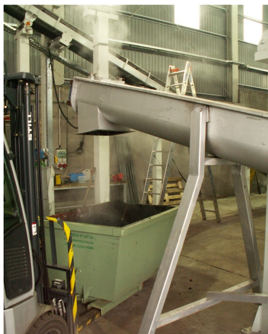
4. ábra: szárított szennyvíziszap konténerbe ürítése
