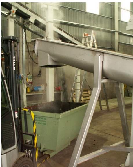
3. ábra: szárított szennyvíziszap konténerbe ürítése
