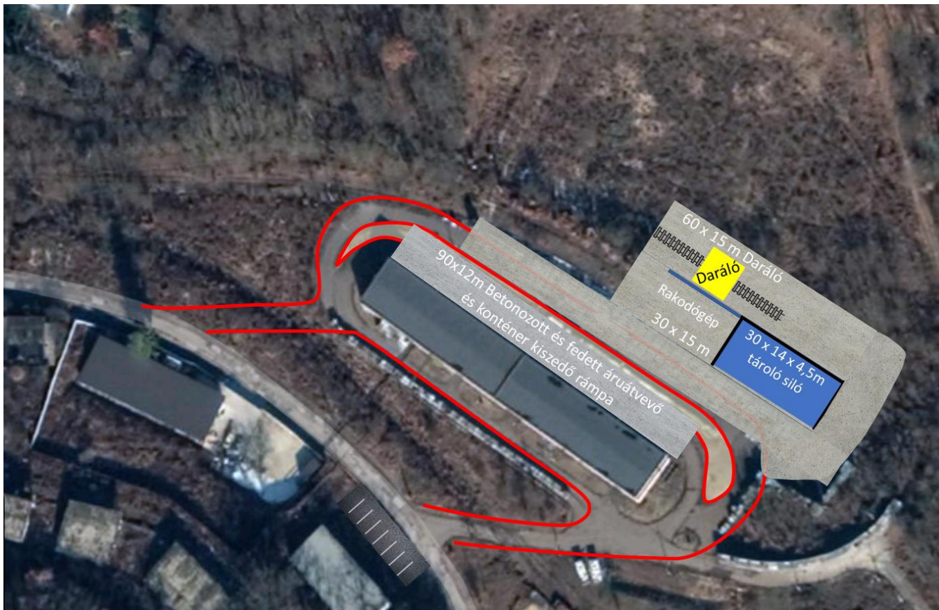
Ábra 5 Logisztikai centrum és a daráláshoz szükséges műtárgyak és berendezések telepítési tervezete
