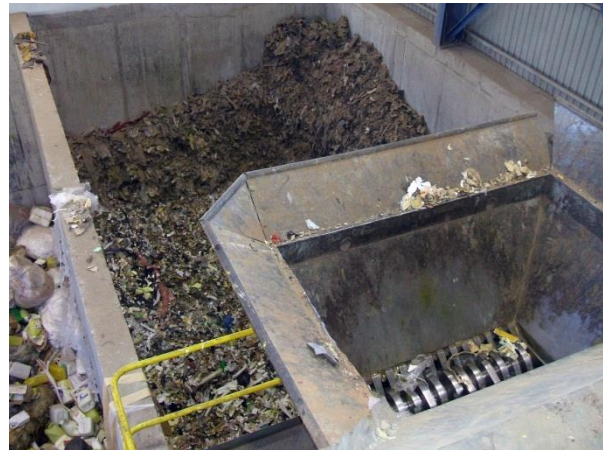
A hulladéktároló siló második (belső) része a forgódobos égető darálójának adagoló garatjával
